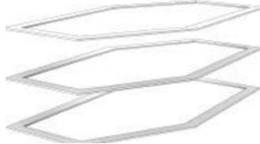
Es werden je Stockwerk umlaufende Deckenvorsprünge hinzugefügt, die bei steil stehender Sonne im Sommer die Fassade verschatten und im Winter solare Gewinne ermöglichen. Dieses Prinzip funktioniert in der Simulation nur mäßig, da mit hoher Wahrscheinlichkeit ein größerer Überstand benötigt werden würde, um messbar positive Aspekte zu erzielen.
