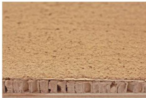
PCM Lehm- bauplatten mit Kohlefaserinfrarotgewebe
